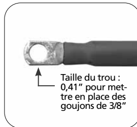
Fig. 3,13. Terminaison câble positif
